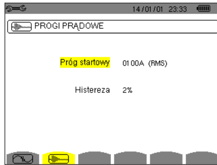
Rysunek 30: ekran Progi prądu rozruchowego w menu Tryb prądu rozruchowego
