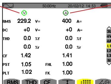
Coloana de valori pentru curent. Valorile RMS, DC (dacă senzorul de curent permite), THD și CF.
