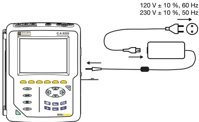
Scoateți capacul prizei și conectați la aparat jack-ul blocului de alimentare respectiv. Conectați cablul de alimentare la blocul de alimentare și la rețea.
