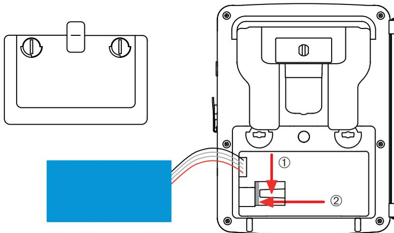
Pentru a pune la loc cardul, glisați-l orizontal în locașul său, până când este împins complet și limba reachează în poziție. Apoi puneți la loc bateria și capacul bateriilor, așa cum se arată în §17.3.
