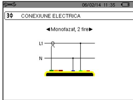
Figura 12 : Conexiune monofazată cu 2 fire
