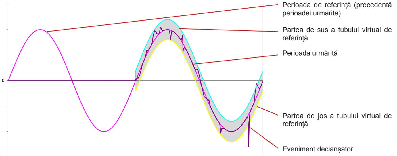
Semilărgimea tubului virtual pentru tensiune și curent este egală cu pragul programat în modul Tranzitoriu al configurației (vezi § 4.8).
