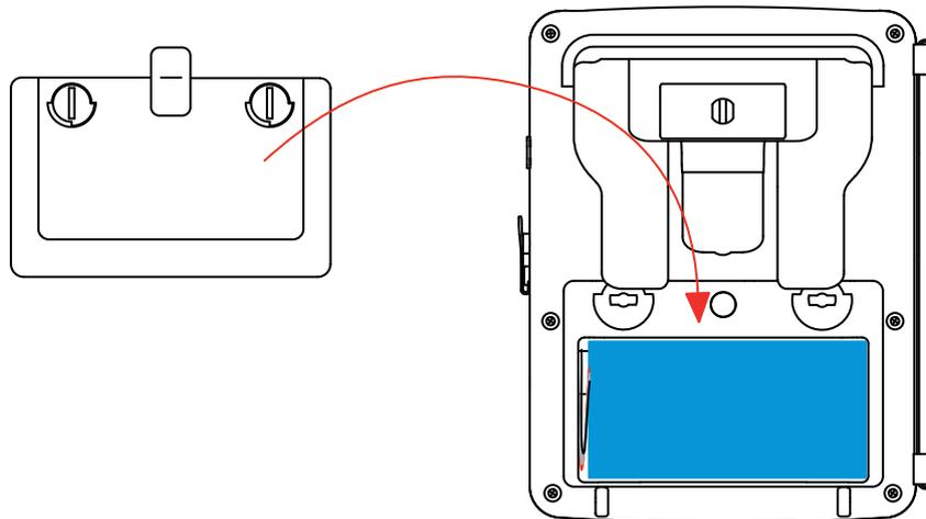
**Atenție:** În cazul deconectării bateriei, chiar dacă aceasta nu a fost înlocuită, trebuie neapărat efectuată o reîncărcare completă. Aceasta pentru a-i permite aparatului să cunoască starea de încărcare a bateriei (informație care se pierde la deconectare).
