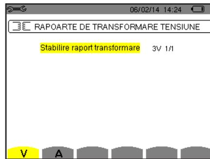
Figura 28 : Ecranul Divizoare de tensiune, din meniul Senzori și divizoare în cazul unui montaj cu nul
