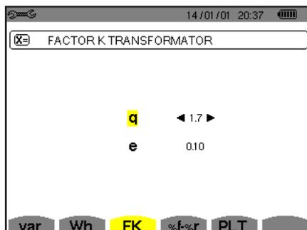
Figura 23 : Meniul Alegerea coeficienților pentru calcularea factorului K
