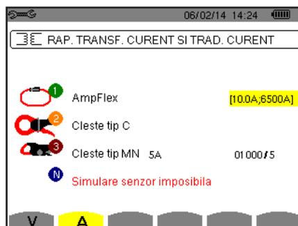
Figura 26 : Ecranul Senzorii și divizoare de curent din meniul Senzorii și divizoare
