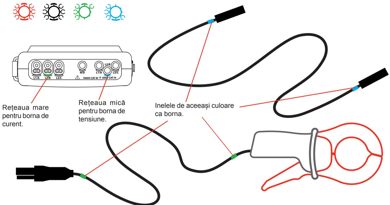
Figura 10 : Identificarea cablurilor și a bornelor
