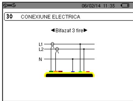
Figura 13 : Conexiune bifazată cu 3 fire
