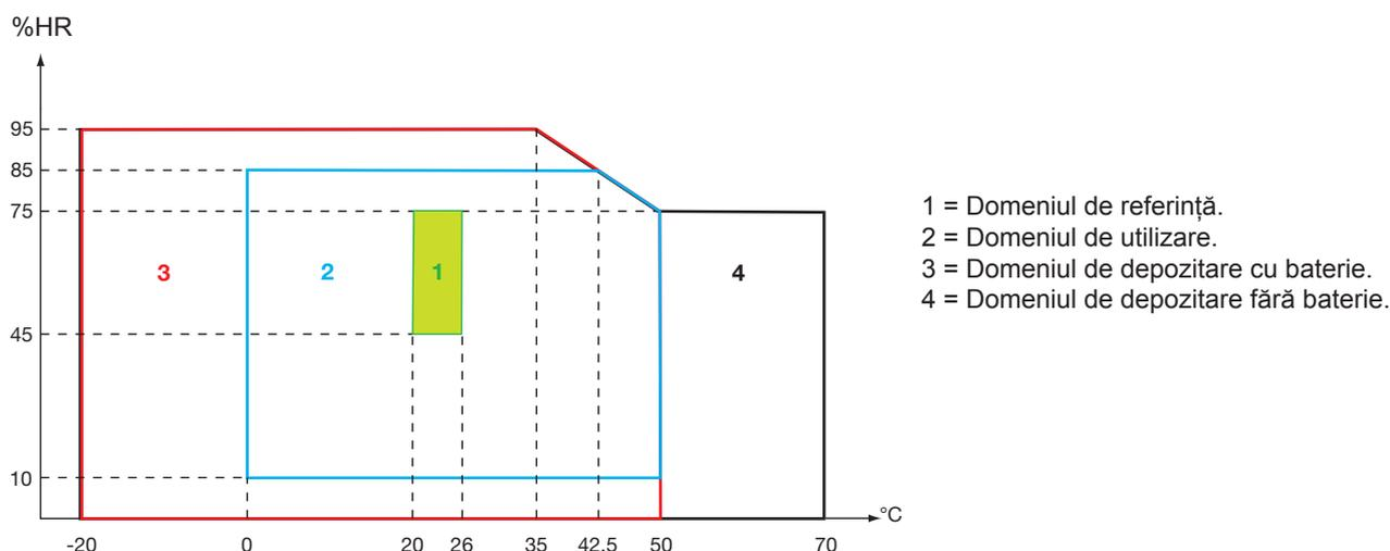
**Atenție:** La peste 40°C, aparatul trebuie utilizat numai pe baterie **SAU** pe blocul de rețea. Utilizarea aparatului simultan pe baterie și pe blocul de rețea externă este **interzisă**.
