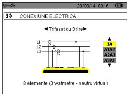
Figura 14 : Conexiune trifazată cu 3 fire
