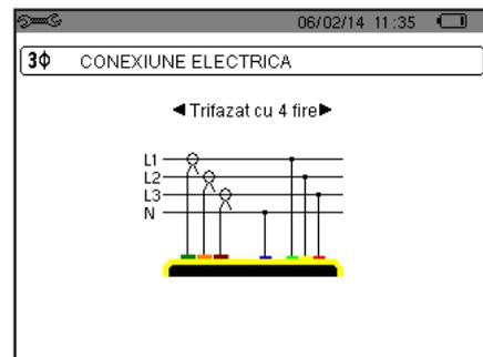
Figura 15 : Conexiune trifazată cu 4 fire
