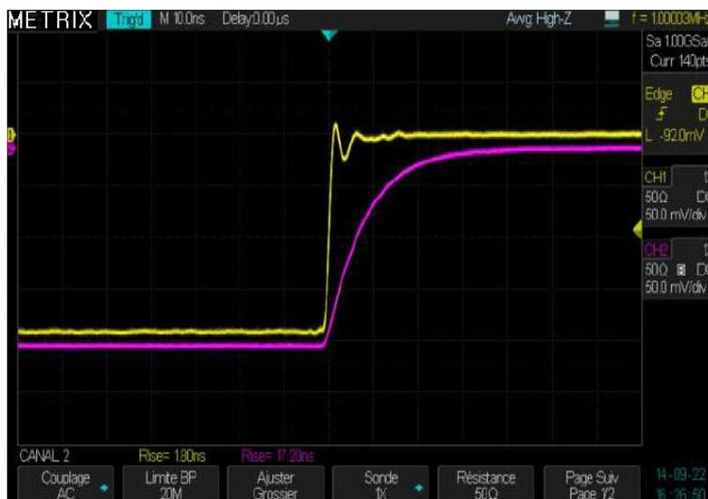
Le temps de montée affiché est de **1.8ns** sur la voie CH1 et **17.20ns** sur la voie CH2, la présence du limiteur de bande « **bandwidth limit** » sur la voie CH2 se traduit par un temps de montée plus lent.
