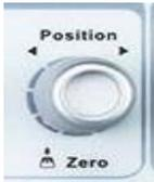
Les boutons du pavé HORIZONTAL permettent de régler le coefficient de balayage « **S/div** » et la « **Position** » horizontale des traces.
