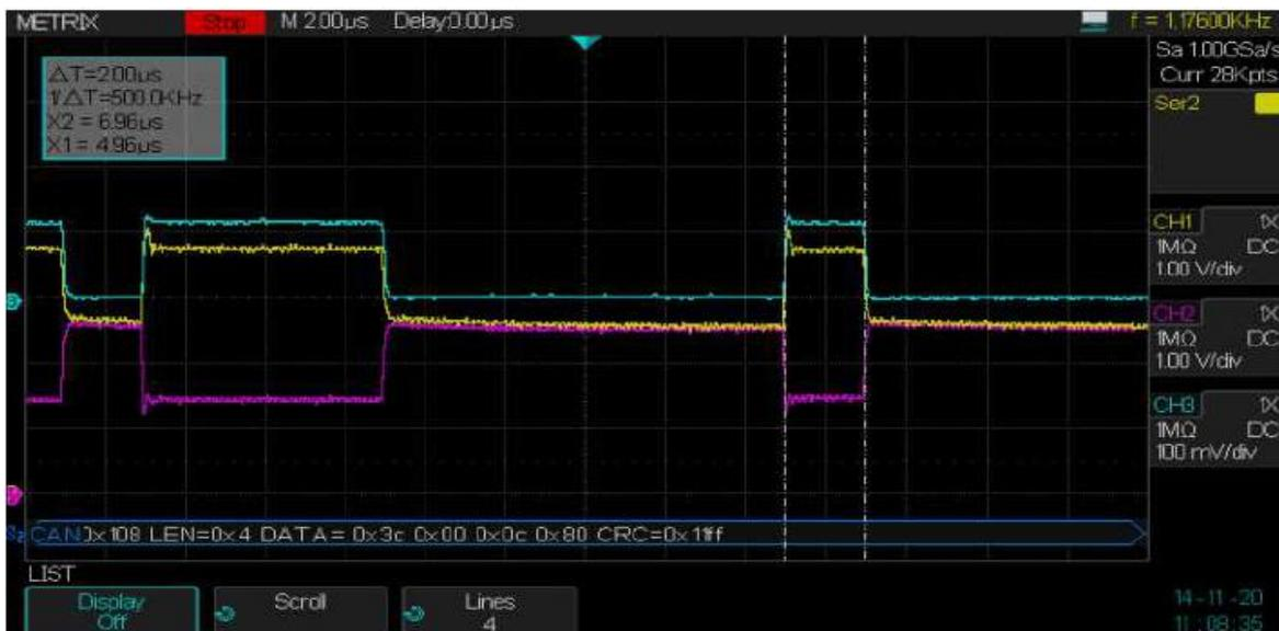
En STOP nous avons dilaté l'échelle horizontale afin d'observer les détails de la trame CAN et de mesurer la largeur d'un bit CAN HS (High Speed) 500kb/s avec les curseurs manuels :
