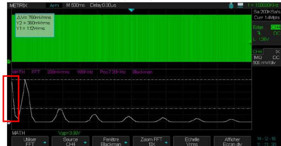
Nous obtenons une amplitude du fondamental (1kHz) de 1.12Vrms (proche de  $1.06\text{Vrms} = 1.5\text{V} / 1.414$ )
