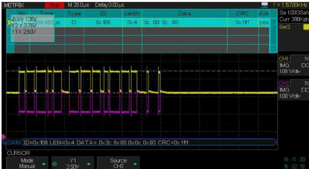
Amplitude du signal CAN\_L HS :
