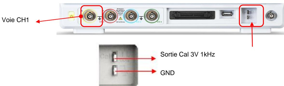
3. Appuyez sur la touche "**Auto Setup**" pour afficher le signal carré de fréquence 1kHz et d'environ 3V d'amplitude crête à crête.
