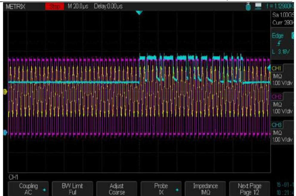
Si l'on appui sur la touche «Run/Stop»: les acquisitions sont relancées avec la configuration correspondant à la trace rappelée, l'affichage est rafraîchi (remarque : la configuration initiale est perdue)
