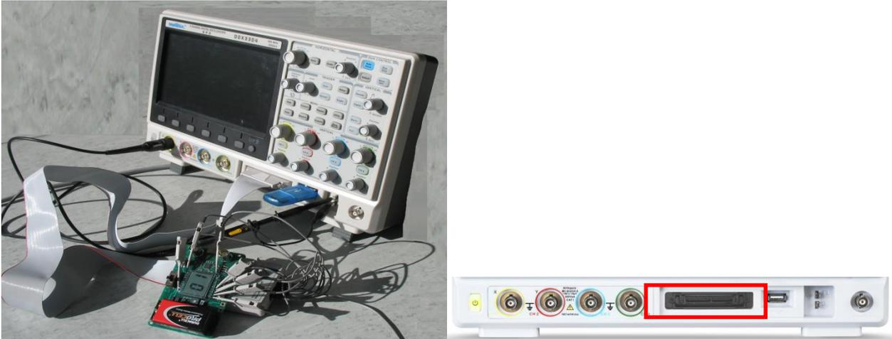
3° Connecter la sonde Digitale 8 entrées au circuit à tester
