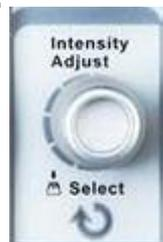
Il est utilisable avec de nombreuses fonctions, par exemple pour ajuster le « Holdoff », déplacer les curseurs, régler la largeur de l'impulsion, définir la ligne vidéo, régler les masques X et Y avec la fonction « Bon/Mauvais » etc. Le bouton "Universel" permet de sélectionner l'emplacement des fichiers configuration, trace et image lors de la sauvegarde/rappel, et de choisir les options des menus.
