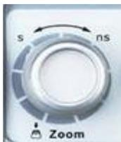
1. Permet d'ajuster le coefficient de balayage. Si l'acquisition du signal est arrêtée (utilisation du bouton RUN/STOP ou SINGLE), tournez le bouton « **S/div** » pour étendre ou comprimer la trace.
