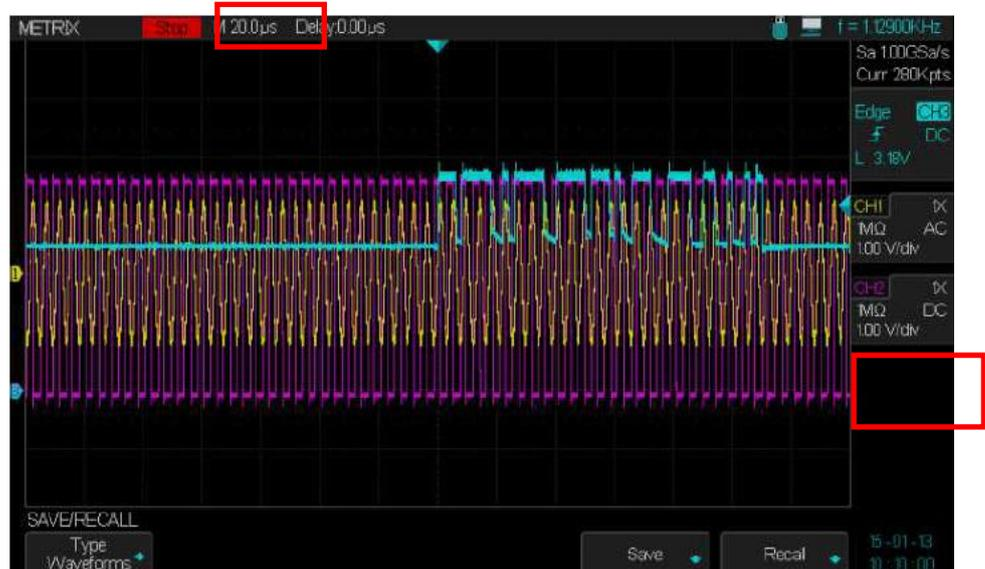
Il faut appuyer sur l'une des touches voie (CH1 par exemple) pour que le calibre V/div de la trace rappelée (CH3) s'affiche.
