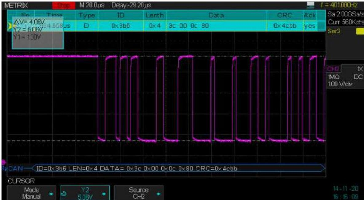
Mesures automatiques de l'amplitude et des temps de montée des signaux CAN LS
