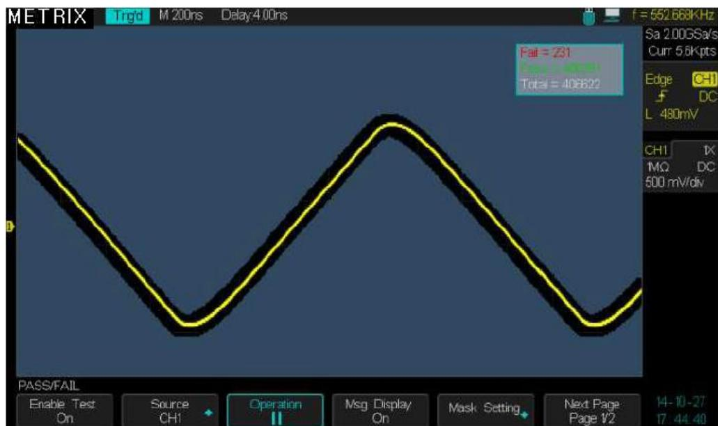
Une fois que le test « Pass/Fail » est validé et lancé l'oscilloscope affiche (Msg Display : On) le nombre de tests défectueux, le nombre de tests bons et le nombre total de test.
