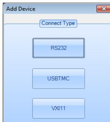
Cliquez ensuite sur l'interface de communication à utiliser USBTMC (USB) ou VXI11 (Ethernet).
