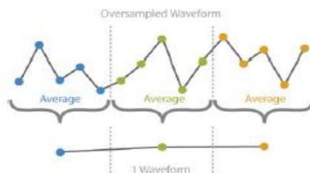
**High Res** Le mode Haute Résolution (**High Res**) utilise le sur-échantillonnage et le moyennage à la volée. Chaque point affiché représente la moyenne des échantillons acquis dans l'intervalle de temps élémentaire. Le mode «**High Res**» augmente la résolution verticale effective de l'oscilloscope. Le mode d'échantillonnage Haute Résolution (High Res) permet de réduire le bruit aléatoire du signal.
