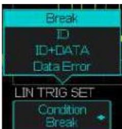
**Break** L'oscilloscope se déclenche sur un « **Sync Break exit** » début de trame
