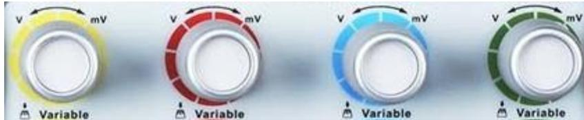
L'échelle verticale peut être ajustée « **par bonds** » (séquence 1-2-5) et en continu « **Fin** », la plage de sensibilité verticale va de 2mV/div à 10V/div.
