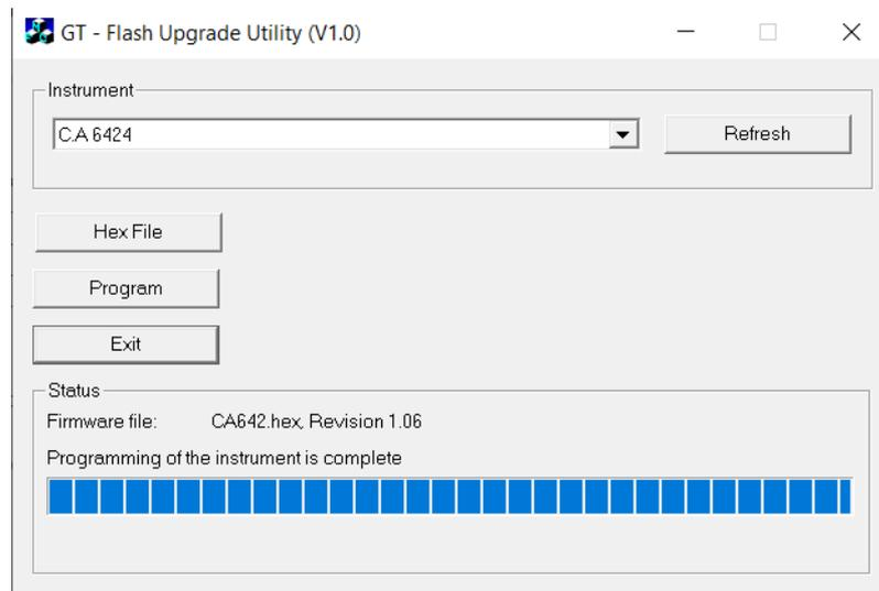
Une fois le téléchargement terminé, l’utilitaire affichera “ Programming of the instrument is complete.
