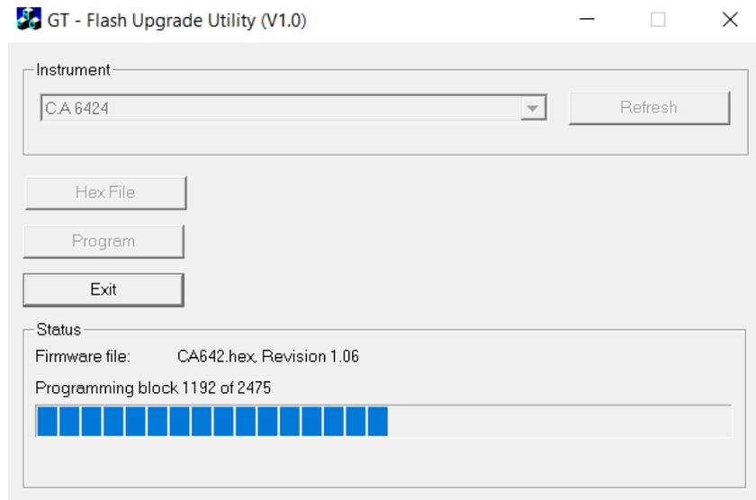
Le téléchargement est en cours... Sur le produit, le bouton “ TEST “ doit clignoter et l’écran doit afficher “ FLSH “.
