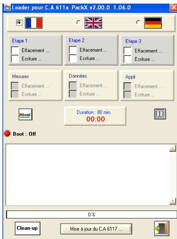
Afin de mettre à niveau le micrologiciel de votre C.A 611X, cliquez sur le bouton « [Mise à jour du C.A 611x..](#) » et suivez pas à pas la procédure décrite dans chaque fenêtre qui sera affichée par l'utilitaire.
