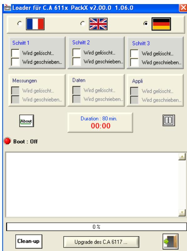
Klicken Sie nun auf den Button "**Upgrade of C.A 611x...**", um die Firmware in Ihrem C.A 611x-Prüfer zu aktualisieren und befolgen Sie bitte genau die Hinweise in den vom Programm eingeblendeten Pop-Up-Fenstern.
