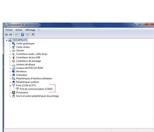
Hier erscheint kein neuer USB-COM Anschluss. Der C.A 611x-Prüfer wird nicht erkannt (oder sein Kabel ist nicht eingesteckt)
