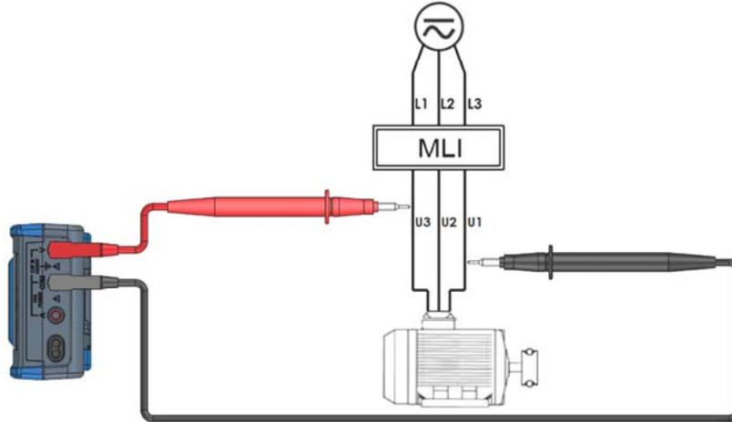
*Raccordement du multimètre pour filtrer un courant > 300 Hz*
