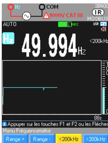
Sélectionnez la fonction Hz pour mesurer la fréquence de la tension
