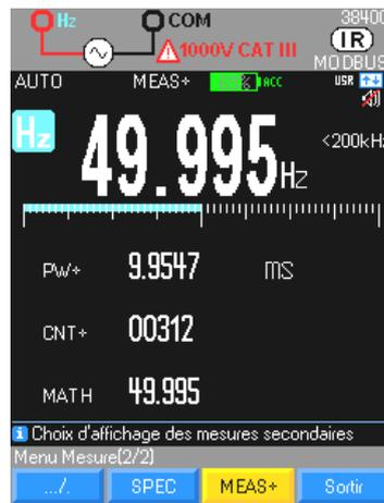
Suivant les conditions de déclenchement du fréquencemètre, calcul des impulsions positives ou négatives
