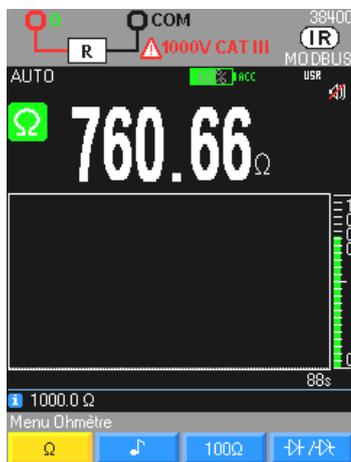
Dans la gamme 50 M $\Omega$ , afin d'éviter l'influence du réseau et de garantir les spécifications annoncées, il est conseillé de déconnecter le multimètre du Wall Plug.
