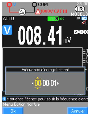
Validation de **Fréq.** par la touche [F3] ouvre un menu de réglage de la cadence d'enregistrement désirée en heure, minute, seconde
