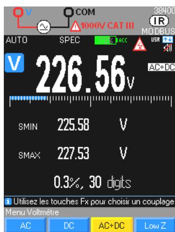
Sur cette position, l'utilisateur peut mesurer la valeur efficace vraie d'une tension alternative avec sa composante continue (pas de couplage capacitif) : mesure dite **TRMS**.
