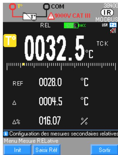
Mesure de la température par le biais d'un thermocouple entre les 2 bornes V et COM en °Celsius
