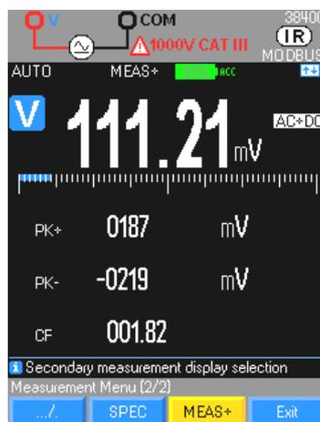
Les mesures de peak rapides sont accessibles dans les mesures secondaires **MEAS**, **MEAS+**, **PK+** et **PK-** pour les fonctions de mesures suivantes : V et A (AC, AC+DC) ; temps d'intégration sous 250  $\mu$ s.
