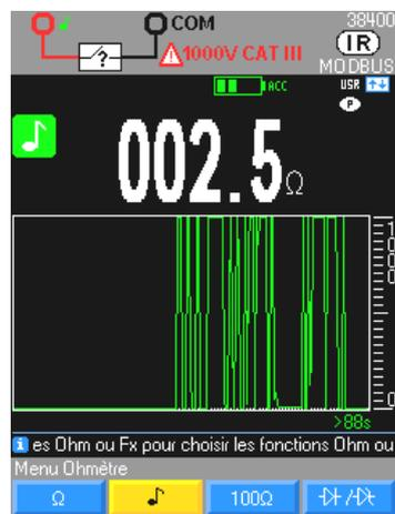
Mesure de la valeur d'une résistance jusqu'à 1000 Ω, avec indication sonore continue à 4 kHz.
