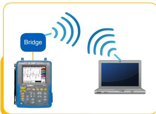
Eine weitere Anwendung ist möglich, indem man den Zugangspunkt HX0090 im Ad-Hoc-Modus betreibt. In diesem Fall können Oszilloskop und PC direkt miteinander kommunizieren. Unter Ad-Hoc-Netzen versteht man Funk-Netzwerke, die sich ohne vorgegebene Infrastruktur selbst organisieren. Allerdings gibt es zahlreiche Probleme bei Ad-Hoc-Netzen, wie begrenzte Bandbreite, Datenverluste, eingeschränkte Sicherheit, Funkstörungen usw...
