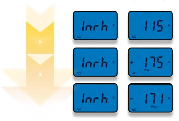
La fonction True **InRush** répond à une problématique récurrente qui correspond au bon dimensionnement des installations électriques, tant au niveau des conducteurs que des protections mises en place.
