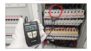
Kompakte, universell einsetzbare TRMS AC+DC-Vielfachmesszange mit Leistungsmessfunktion.
