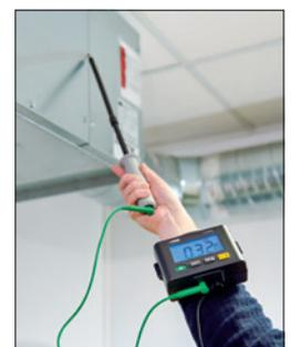
Stab für Durchgangsprüfung
