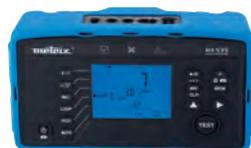
Transférez, via Bluetooth, les résultats de tests mémorisés dans le MX 535. Des rapports de tests sont alors générés puis envoyés automatiquement par courrier électronique, ou bien simplement stockés pour un traitement ultérieur.
