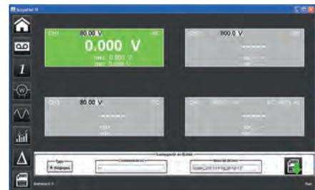
\* Application PC utilisant la communication Ethernet (filaire RJ45 et WiFi) et USB à partir de l'adresse IP.
