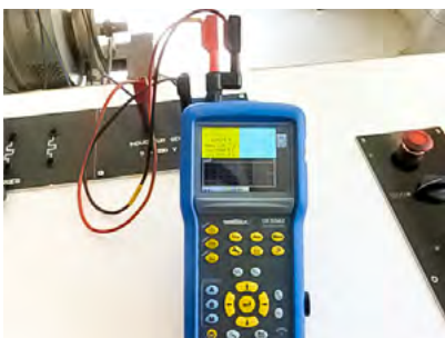
Ici, la voie 1 du HandScope est connectée à l'inducteur via l'adaptateur BNC/Banane.
