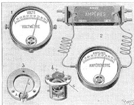
Fig. 1 à 4. — Appareils de mesure électrique de MM. Arnoux et Chauvin. — 1. Voltmètre. 2. Ampèremètre de 10 centimètres de diamètre relié à son shunt. — 3. Principe de l'appareil. — 4. Équipage mobile.
