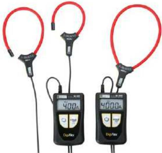
Eficientes, los DigiFLEX son de uso muy sencillo ya que con tan sólo dos botones se puede encender, desactivar el auto apagado, memorizar la visualización (HOLD) o el valor máximo medido (MAX HOLD).
