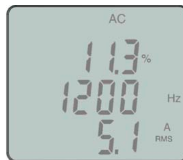
Ecran F407 Mesure d'harmoniques H3 d'une fondamentale à 400 Hz
