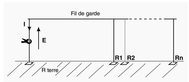
Si on applique la tension E sur n'importe quel point de la mise à la terre de Rx, un courant I circule dans la boucle selon l'équation suivante :
