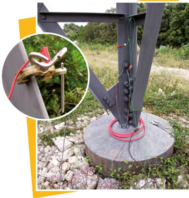
Mesure de terre de pylône à l'aide des C.A 6472 + C.A 6474
