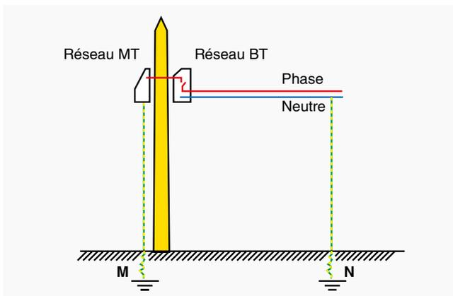
Lors d'un coup de foudre sur le transformateur MT/BT, l'élévation de potentiel instantané peut être de plusieurs kV.
