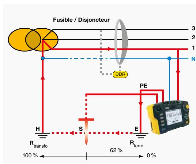
Le principe de mesure reste le même que pour la méthode des 62 % :
