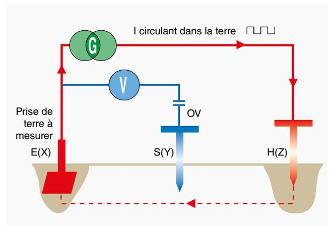
Le principe de mesure consiste à faire circuler à l'aide d'un générateur approprié **G**, un courant alternatif (**I**) constant à travers la prise auxiliaire H dite « prise d'injection courant », le retour se réalisant par la prise de terre E.
