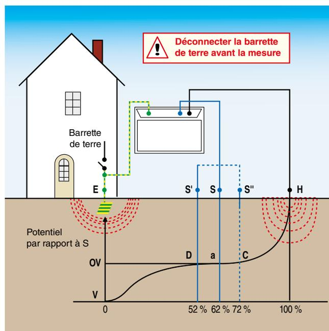
Cette méthode nécessite l'emploi de deux électrodes (ou « piquets ») auxiliaires pour permettre l'injection de courant et la Référence de potentiel 0 V. La position des deux électrodes auxiliaires, pour rapport à la prise de terre à mesurer E(X), est déterminante.
