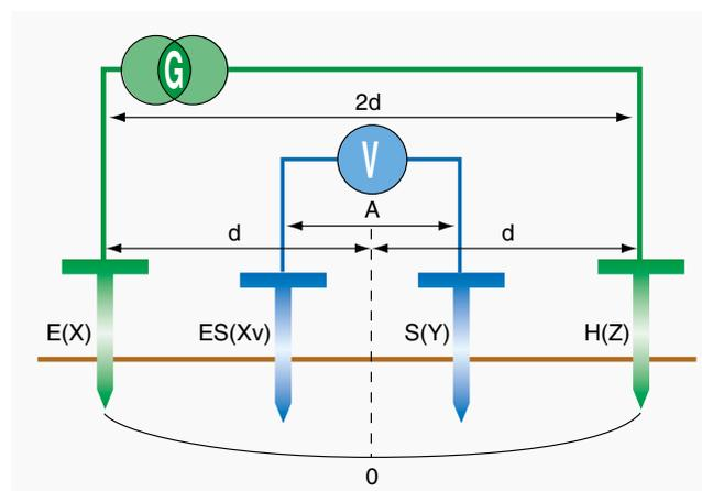
Bien que la méthode de Schlumberger permette de gagner du temps, c'est la méthode de Wenner qui est la plus connue et la plus utilisée. Sa formule mathématique est plus simple. Cependant, de nombreux appareils de mesure Chauvin Arnoux intègrent les deux formules de calcul permettant d'obtenir instantanément les valeurs de résistivité par l'une ou l'autre des deux méthodes.
