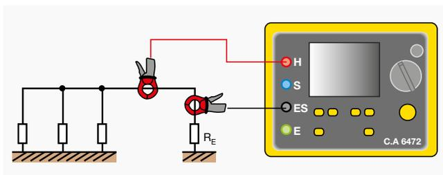
Au lieu d'avoir une pince unique comprenant le circuit générateur et le circuit récepteur, deux pinces sont utilisées où l'une sert de générateur et l'autre de récepteur. L'intérêt d'avoir une pince par fonction est de réaliser des mesures sur des conducteurs où la pince de terre n'est parfois pas adaptée à cause de son diamètre d'enserrage ou de son épaisseur.
