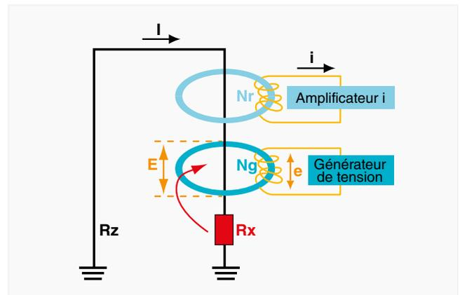
Pour identifier correctement le courant de mesure et éviter les courants parasites, la pince de terre utilise une fréquence de mesure particulière.
