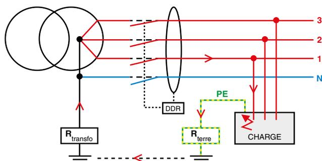
En cas de défaut d'isolement sur la charge, le courant de défaut est évacué par la terre via le conducteur de protection (PE). Selon sa valeur, le courant de défaut, entraîne une coupure automatique de l'installation par la mise en fonctionnement du disjoncteur différentiel (DDR).
