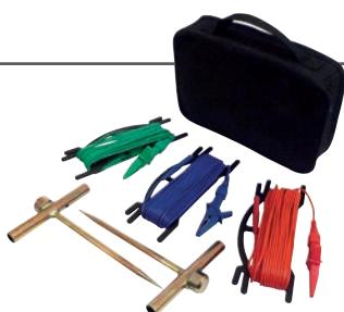
Sacoche contenant : 2 piquets, 3 câbles (15 m rouge, 10 m bleu, 5 m vert) à connectique fiche Ø4 mm mâle de sécurité avec à l'extrémité une pince crocodile isolée, montés sur enrouleur individuel en H.
