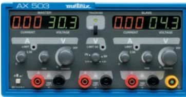
**Alimentatori da laboratorio con uscita singola, doppia e tripla**
