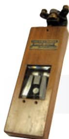
Galvanomètre à réflexion de 1895
