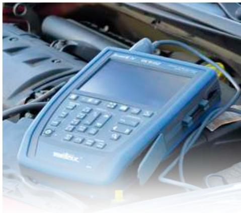
La fonction **BUS** des **SCOPIX IV** permet de réaliser les mesures électriques destinées à évaluer l'intégrité des bus de terrain, c'est-à-dire le fonctionnement de la couche physique (spécifications électriques, synchronisation...), selon les normes en vigueur.
