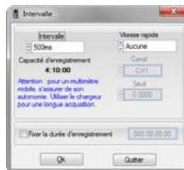
Acquisition, pas minimum 0.2 s sur MTX 3292B / MTX 3293B
