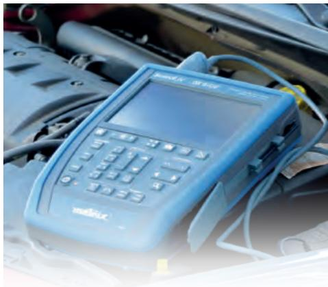
La función **BUS** de los **SCOPIX IV** permite realizar medidas eléctricas destinadas a evaluar la integridad de los buses de campo, es decir el funcionamiento de la capa física (especificaciones eléctricas, sincronización...), según las normas vigentes.
