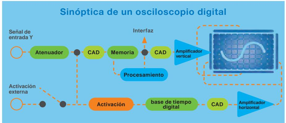
El osciloscopio digital o DSO (Digital Storage Osciloscopio) muestrea y traza estas muestras en función del tiempo; la oferta de osciloscopios digitales existe en 2 familias:
