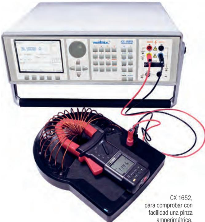
CX 1652, para comprobar con facilidad una pinza amperimétrica.
