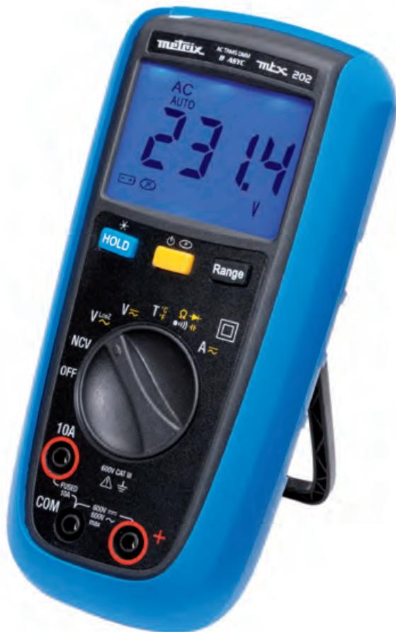
Una línea de 2 multímetros TRMS CA y de 1 multímetro TRMS CA+CC sencillos, básicos con visualización digital para realizar medidas en redes eléctricas, instalaciones de hasta 600 V CAT III. Estos multímetros son instrumentos de medida profesional de uso general o «todo uso».
