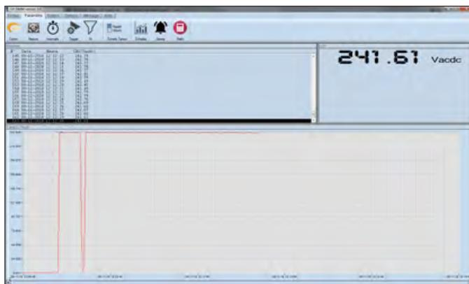
Este software de adquisición de datos permite asociar hasta 4 multímetros controlados por un PC, ya sean multímetros de campo o multímetros de sobremesa.
