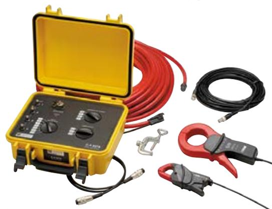
Le C.A 6472 permet de réaliser une expertise complète et rapide de toutes les configurations de mise à la terre. Associé à son accessoire le C.A 6474, il offre la possibilité de mesurer la résistance de terre d'un pylône.
