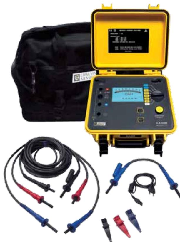
El megaohmetro C.A 6505 se entrega de serie con una bolsa de transporte, cables de 2 m terminados en pinzas de cocodrilo perfectamente aisladas y de gran tamaño, 2 cables de medición y un cable de protección para las mediciones de alto aislamiento.
