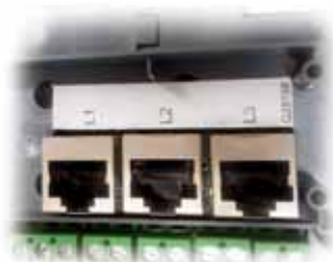
Esempio di interfaccia con collegamento RJ45 (opzione segnali basso livello cod. 11-0000-358)
