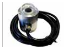
Piranometro misura irraggiamento
