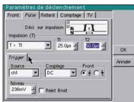
Il trigger effettivo sull'ingresso avverrà dopo l'analisi del tempo dell'impulso rispetto alla fonte principale
