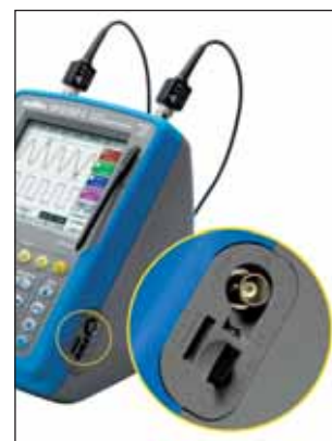
Interfacce di comunicazione e ingresso SD Card
