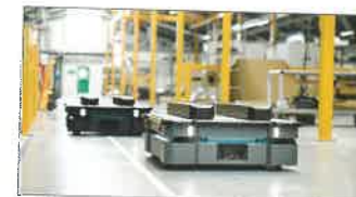
Les nouveaux robots MiR600 et MiR1350 de MiR peuvent respectivement soulever jusqu'à 600 kg et 1350 kg.
