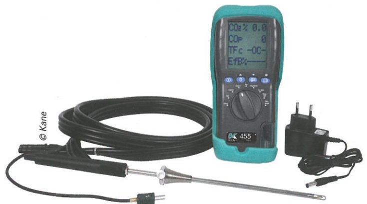
L'analyseur de combustion Kane455 (plus) pour installation fioul gaz et granulés, connecté, dispose de cellules CO et CO 2 , dont la durée de vie et la garantie sont de cinq ans. Il conserve son écran et, en option, une imprimante.
