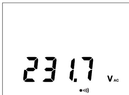
Sulla posizione **MΩ**, il simbolo
