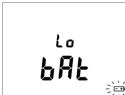
Occorre allora tassativamente sostituire le pile (vedi § 4.2), perché l'indicazione dell'autonomia non è più affidabile.
