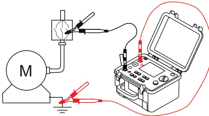
**Pour la mesure de forts isolements (> 1 GΩ),** il est conseillé d'utiliser la borne de garde « G » pour éviter les effets de fuite et capacitifs ou pour supprimer l'influence des courants de fuite de surface. La garde sera connectée sur une surface susceptible d'être le siège de circulation des courants de surface au travers de poussière et d'humidité : par exemple, surface isolante d'un câble ou d'un transformateur, entre deux points de mesure.
