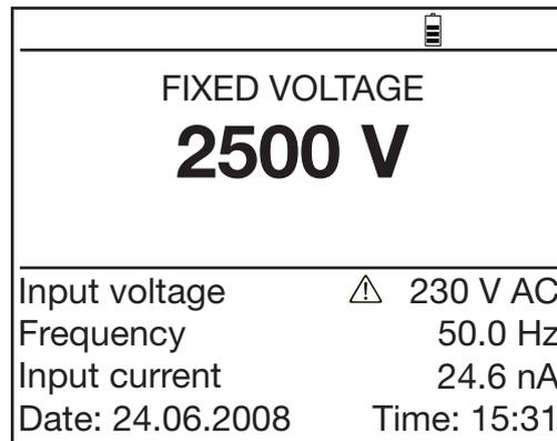
Le lancement des mesures d'isolement est impossible si une tension externe trop élevée est présente sur les bornes. Le symbole ⚠ apparaît à côté de la valeur de la tension externe mesurée (voir § 3.2.).
