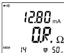
Cuando la medida de impedancia es  $> 1.200 \Omega$ , el instrumento indica **OR**.
