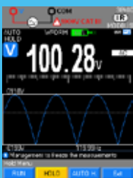
Signal d'un redressement double alternance
