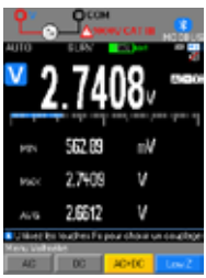
L'écran graphique permet le suivi de baisse de tension en utilisant le mode SURV, afin de récupérer les MIN/MAX horodatés.
