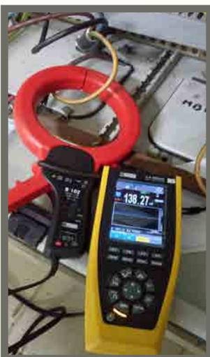
Medida en sistema de calefacción y aire acondicionado: corriente, tensión, temperatura.
