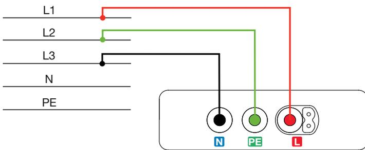
Si visualizzano le tensioni composte, ognuno dei valori  $U_{12}$ ,  $U_{23}$  e  $U_{32}$  alternativamente, nonché il senso di rotazione di fase  $L_3 \rightarrow L_2$  o  $L_1 \rightarrow L_2$ .
