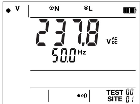
Lo strumento indica se si tratta di una tensione AC o DC.
