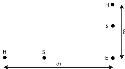
Se ottenete allora i medesimi valori, la vostra misura è affidabile. Se i valori misurati differiscono sensibilmente, è probabile che correnti telluriche o una vena d'acqua sotterranea abbiano influenzato la vostra misura. Può anche rivelarsi utile conficcare i picchetti più profondamente.
