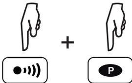
Premete simultaneamente i tasti **•••••** e **P** (per il C.A 6131) o **•••••** e MEM (per il C.A 6133).
