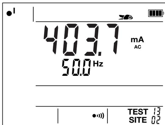
La misura di corrente si effettua unicamente in AC.
