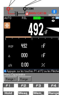
RUN apparaît lorsque la mesure est en cours et OL si la valeur est > à la gamme ou court-circuit.
