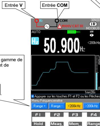
2. Sélectionnez la gamme de mesure Range ± et de fréquence
