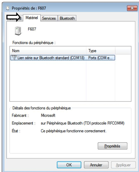
2.3 Connessione dello strumento in corso con il software PAT, mediante Bluetooth. Occorre selezionare solo "Porta COM" per comunicare, e selezionare la porta giusta COM (qui COM18).
