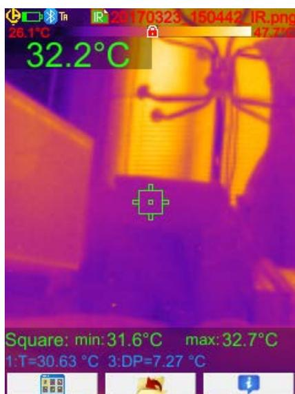
La apertura de una imagen se traduce por el cierre de los menús y la visualización de la imagen en la pantalla principal. La barra de estado cambia (véase § 1.4.1.1. [Barra de estado](#)) y el nombre del archivo aparece en rojo.
