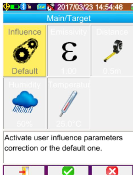
La compensación de los factores de influencia por defecto corresponde al contexto de calibración de la cámara (ejemplo: la emisividad está especificada a 1,00; la distancia a 0,5 m; la humedad al 50% y la temperatura ambiente a 25 °C).
