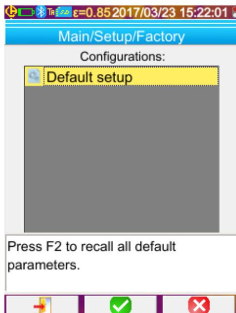
La configuración de fábrica forma parte de las configuraciones predefinidas propuestas en el menú Principal/Configuración/Fábrica.
