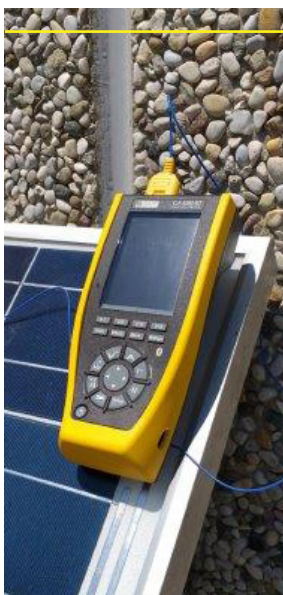
Temperaturmessung an Photovoltaik-Modulen. Die praktische Mehrzweck-Magnethalterung MULTIFIX als Zubehör ermöglicht freihändiges Arbeiten.
