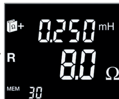
Schermata 3: valore dell'impedenza dell'anello di terra
