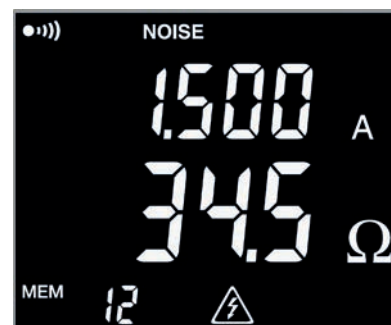
La funzione Tensione di Contatto è attiva qualunque sia la modalità di misura, standard o avanzata.
