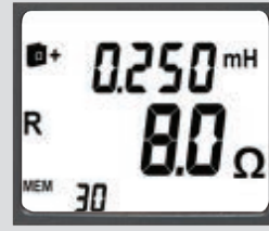
Schermata 3: valore dell'impedenza dell'anello di guasto associata
