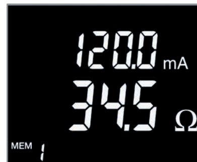
Modalità standard: Impedenza e corrente di dispersione verso terra
