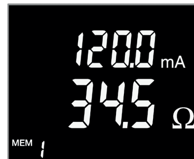
Modo estándar: Impedancia y corriente de fuga
