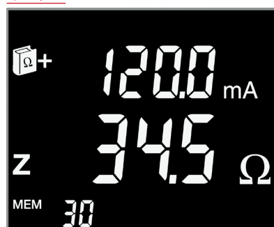
Paso 1: impedancia y corriente de fuga
