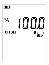
■ Si quiere seguir con la calibración, saque el electrodo de la solución, enjuáguelo con agua desmineralizada, séquelo, sumérjalo en la segunda solución tampón y pulse de nuevo la tecla **CAL**.
