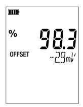
Durante las calibraciones, los valores de la pendiente y de la asimetría para un mismo electrodo deben variar poco. Si observa una variación importante, puede resultar necesario volver a realizar la calibración, compruebe el estado de las soluciones tampón (especialmente la fecha de caducidad), o sustituya el electrodo.
