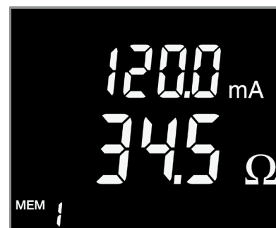
Mode standard : Impédance et courant de fuite
