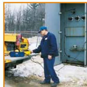
In situ, medida en un transformador trifásico 2.000 Kva
