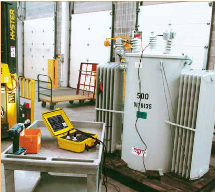
El DTR® 8510 es un medidor de relación de transformación digital portátil diseñado para controlar los transformadores de potencia, de potencial y de corriente. Conectado a un transformador fuera de tensión, el DTR® permite medir con precisión la relación entre el número de vueltas de bobinado del primario y el número de vueltas de bobinado del secundario, mientras visualiza la polaridad y la corriente de excitación.
