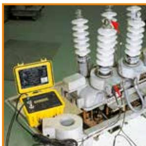
Medida de la relación de un transformador de corriente
