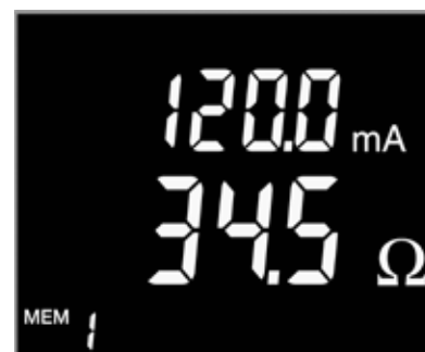
Mode standard : Impédance et courant de fuite
