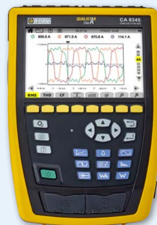
Schermata 2: malfunzionamento con aumento della corrente e intervento dell'interruttore
