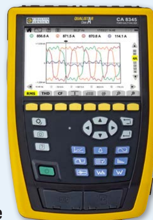
Ecran 2 : défaut avec augmentation du courant et déclenchement du disjoncteur
