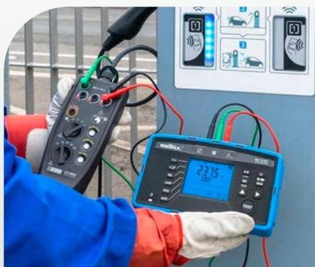
Contrôle des tensions délivrées par une borne avec DDR de type A, lors de la charge
