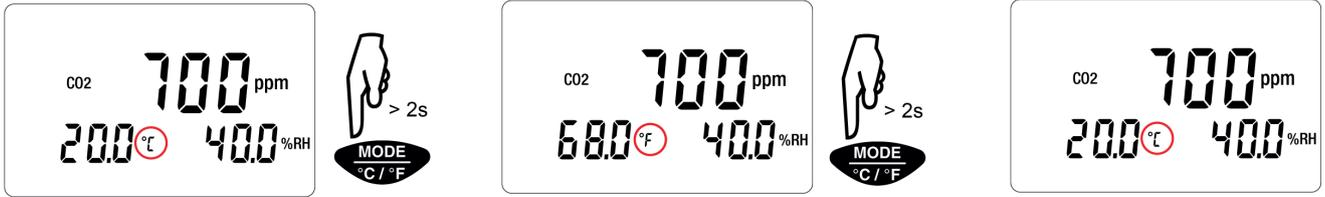
La elección de la unidad de temperatura se guarda al apagar el instrumento.
