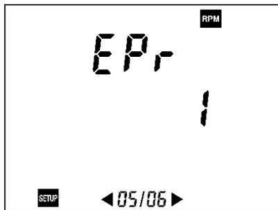
Abbildung 53: Anzeige des mit der Anzahl der Ereignisse pro Umdrehung des tachymetrischen Signals verbundenen Parameters.
