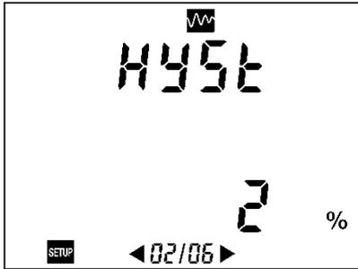
Abbildung 48: Anzeige des mit der Hysterese verbundenen Parameters.
