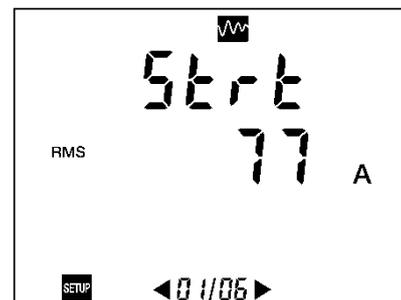
Abbildung 47: Anzeige des mit dem Ausgangsstroms verbundenen Parameters.
