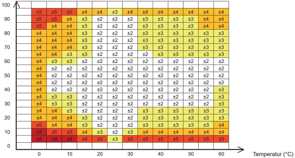
Die relative Feuchtigkeit hängt stark von der Temperatur ab. Um eine Kalibrierung des Geräts auszuführen, müssen beide Fühler (Referenz und Gerät) die gleiche Temperatur anzeigen.
