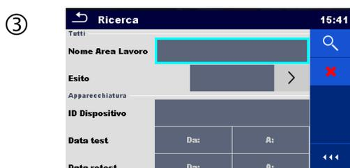
I parametri che possono essere cercati sono visualizzati nel menu di impostazione della ricerca. Nome e stato sono riferiti a tutti gli oggetti struttura. Se si effettua una ricerca per stato, lo strumento visualizza tutti gli oggetti struttura che includono uno o più rilevamenti con stato ricercato. ID dell'apparecchio, Data del test, Data del nuovo test si riferiscono solo ai seguenti oggetti struttura: Apparecchio, apparecchiatura FD, macchinario e quadro elettrico.
