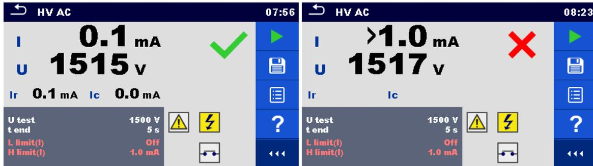
Figura 6.24: Esempi di risultati di rilevamento AC HV
