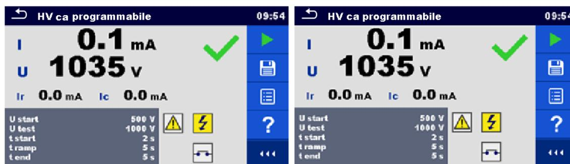
Figura 5.19: Esempi di risultati dei test programmabili AC HV
