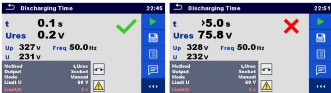
Figura 5.53: Esempi di risultati di rilevamento del tempo di scarica (uscita = presa)
