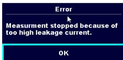
La dispersione di corrente rilevata ( $I_{diff}$ ,  $I_{pe}$ ,  $I_{touch}$ ) era superiore ai 20 mA. Il rilevamento è stato interrotto. Premere **OK** per continuare.
