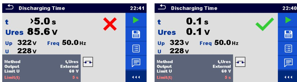
Figura 5.51: Esempi di risultati di rilevamento del tempo di scarica (uscita = esterna)
