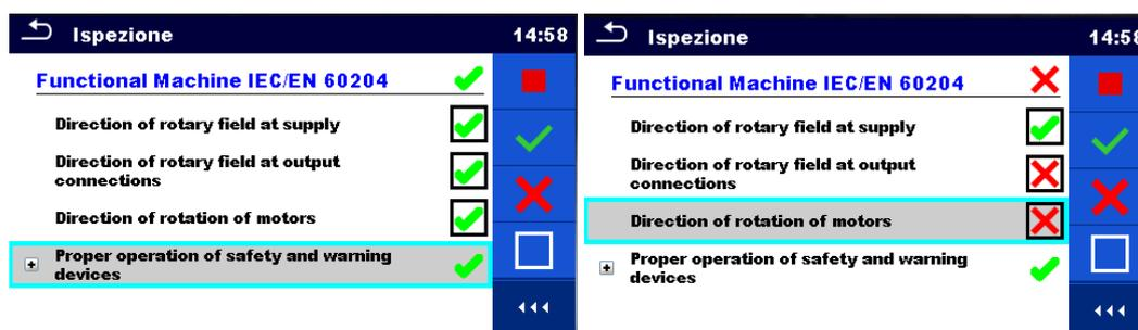
Figura 5.56: Esempi di risultati dell'ispezione funzionale
