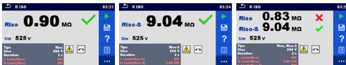
Figura 5.27: Esempio di risultati di rilevamento di resistenza di isolamento
