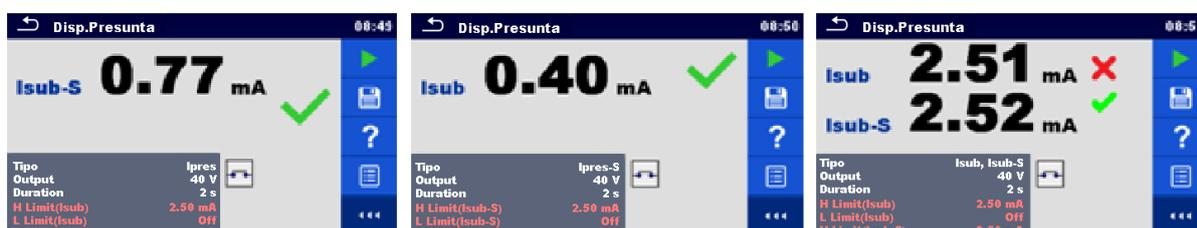
Figura 5.32: Esempi di risultati del rilevamento di sostituzione di dispersione
