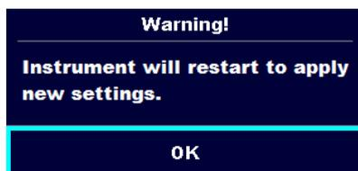
Avvertimento del riavvio dello strumento per impostare i parametri Ethernet. Questo messaggio appare all'uscita del menu Parametri dopo la modifica dei parametri Ethernet. Premere **OK** per continuare.
