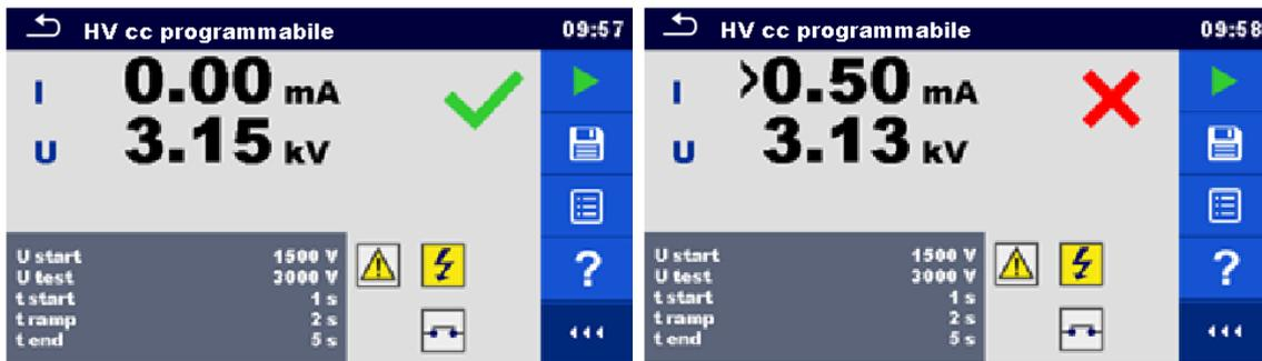
Figura 5.22: Esempi di risultati dei test programmabili DC HV
